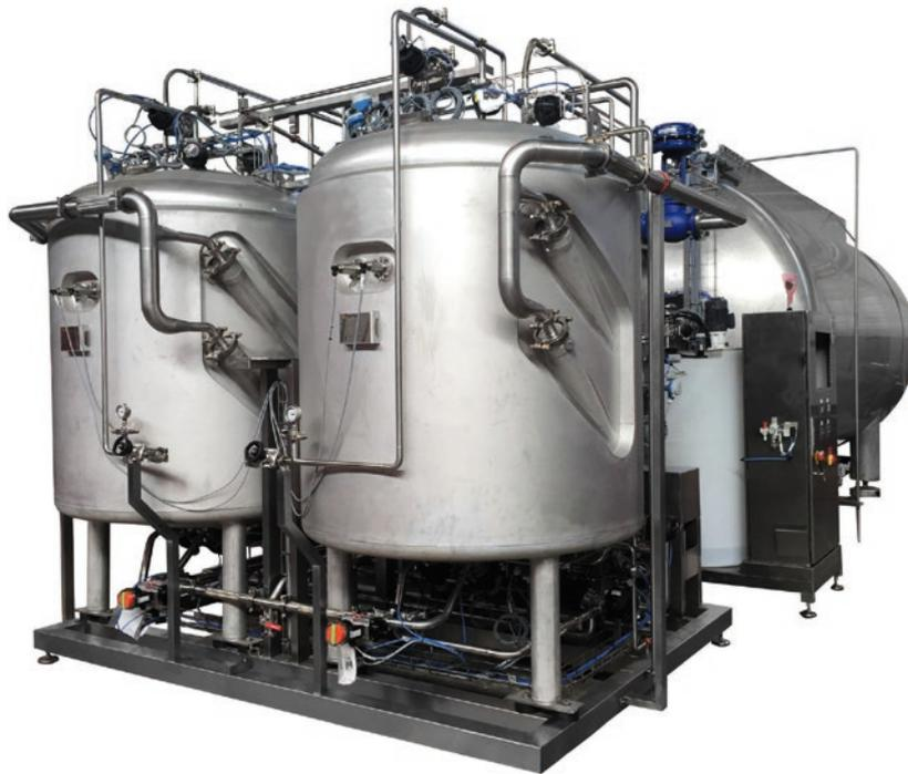
Предназначены для обеззараживания биологических отходов и сточных вод перед сливом в канализацию – уничтожения патогенных микроорганизмов I-IV группы опасности. Стерилизацию стоков производят путем термической обработки, варьируя время процесса и температуру нагревания.
